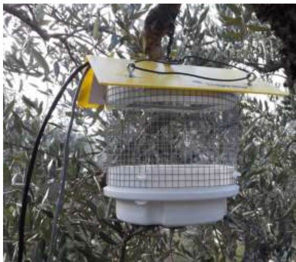
Figura 3. Trappola trapview per il monitoraggio automatico dei voli degli adulti di mosca delle olive.
