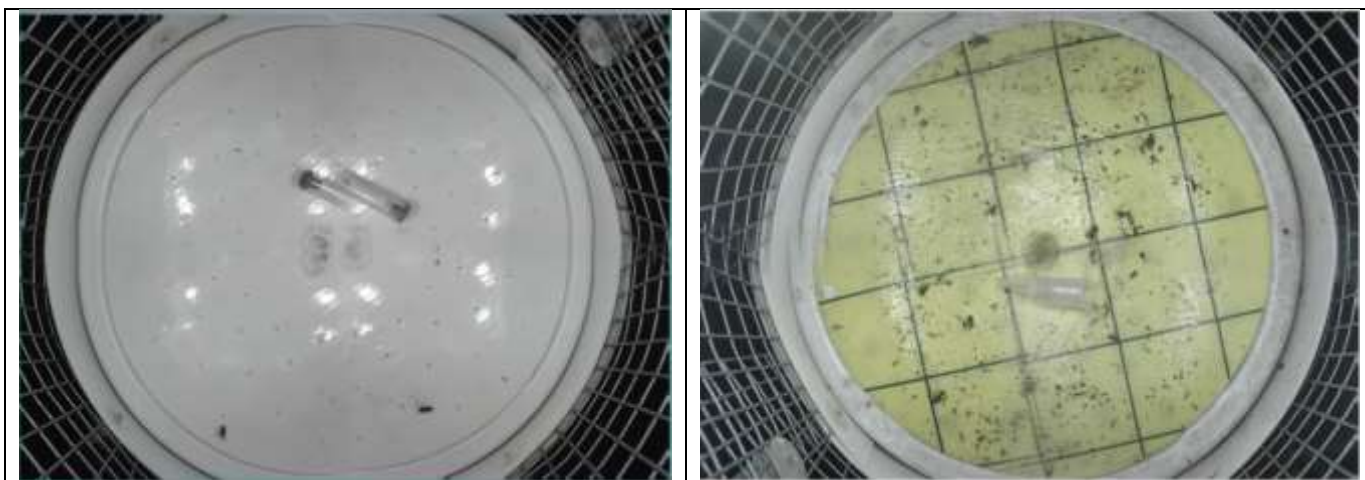
Figura 4. Confronto tra il disco collosa per la cattura degli adulti di mosca delle olive fornito dalla ditta produttrice (a sinistra) e quello modificato per il miglioramento della capacità di cattura (a destra).
