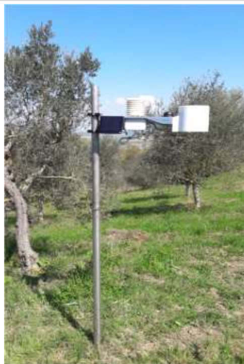
Figura 5 Stazione agrometeorologica della Metos - Pessl Instruments per il rilievo della temperatura e delle piogge posizionata nell'oliveto di località Zona Lago.
